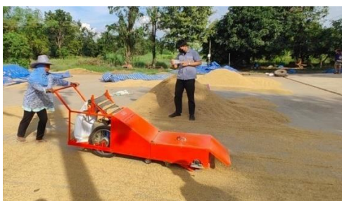
ภาพที่ 6 เกษตรกรผู้ปลูกข้าว ทดลองใช้รถเก็บข้าวเปลือกจากลานตากคอนกรีต V.2
