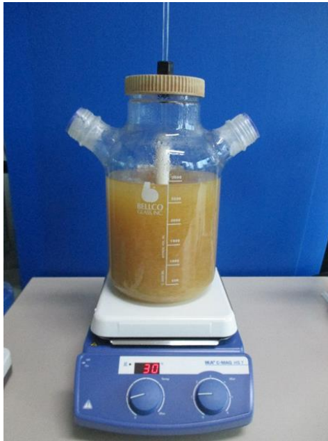
ภาพที่ 1 การเพิ่มปริมาณเอนไซม์โคติเนสใน spinner flask บน hot plate stirrer
