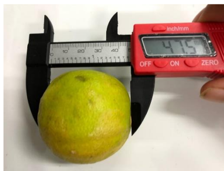
ภาพที่ 14 การวัดขนาดมะนาวด้วยเวอร์เนีย
