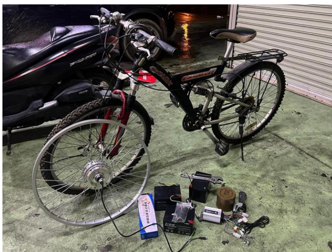
ภาพที่ 1 รถจักรยานเสือภูเขา ที่ใช้เป็นรถต้นแบบในการทำรถจักรยานไฟฟ้า
