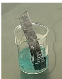
ภาพที่ 1 การทดลองเคมีไฟฟ้า หัวข้อ ปฏิกิริยารีดอกซ์ระหว่างโลหะสังกะสีและสารละลายคอปเปอร์(II)ซัลเฟต
