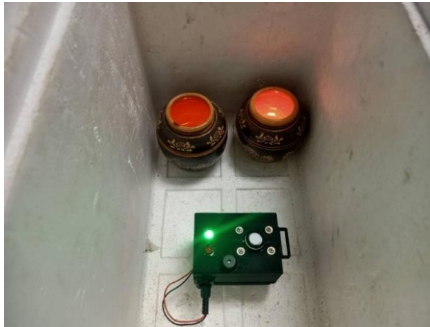
ภาพที่ 9 การทดสอบการทำงานของอุปกรณ์ตรวจวัดปริมาณออกซิเจนในพื้นที่อับอากาศ
