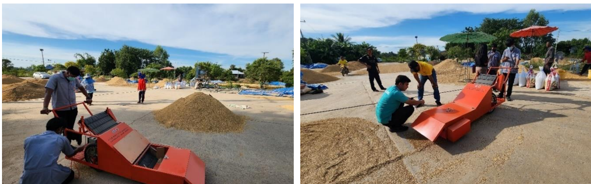
ภาพที่ 5 ทดสอบความถูกต้องในการทำงานของรถเก็บข้าวเปลือกจากลานตากคอนกรีต V.2
