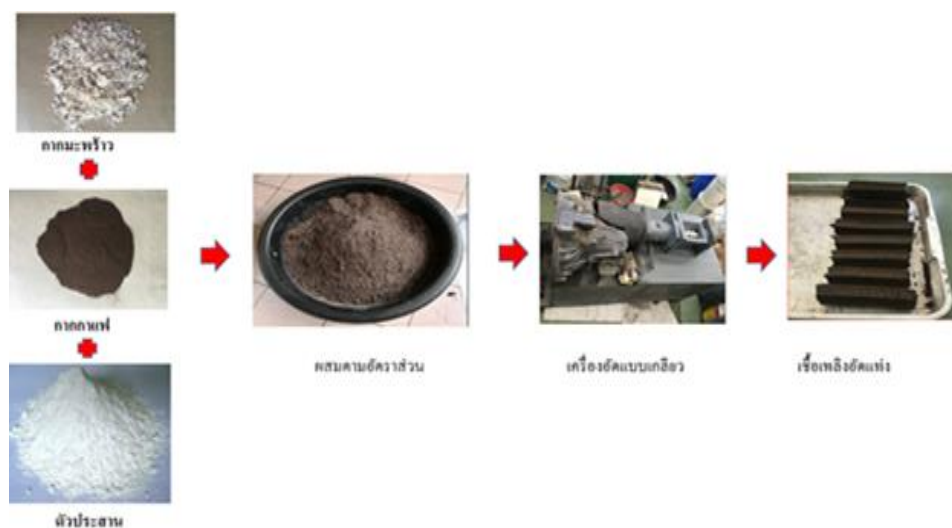
ภาพที่ 3 วิธีการขึ้นรูปเชื้อเพลิงอัดแท่ง
