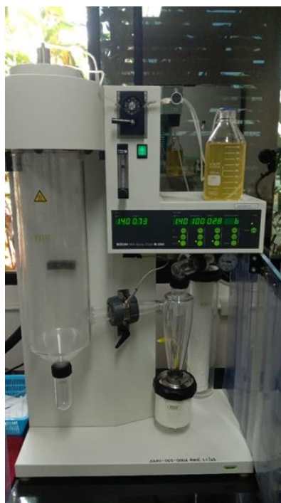
ภาพที่ 2 เครื่องพ่นแห้งแบบฝอยในการทำเอนแคปซูเลตโคติเนส
