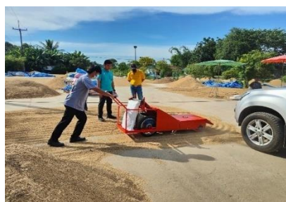
ภาพที่ 6 เกษตรกรผู้ปลูกข้าว ทดลองใช้รถเก็บข้าวเปลือกจากลานตากคอนกรีต V.2
